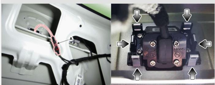
**6** Снимите **камеру заднего вида**, выверните **четыре длинных** и **четыре коротких** винта крепления камеры.
