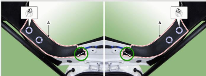
**3** Снимите **накладку** ручки закрывания багажного отделения.
