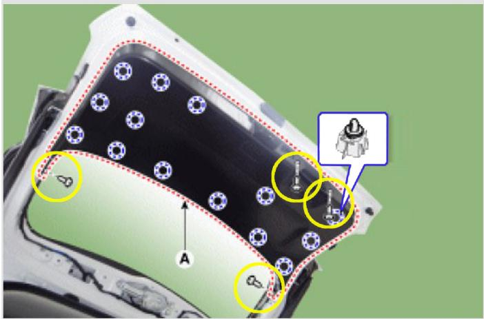
**5** Отсоедините **разъем камеры**, нажмите на **фиксаторы** и выполните пункт **6**.
